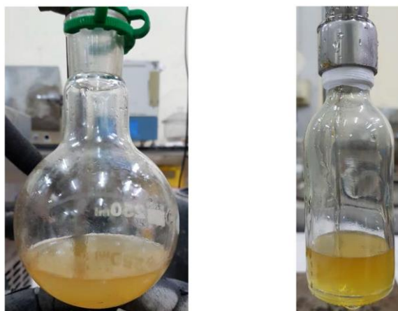
ภาพประกอบ 55 ไบโอดีเซลเฟสน้ำได้จากชุดควบแน่นด้วยเครื่องทำความเย็น
