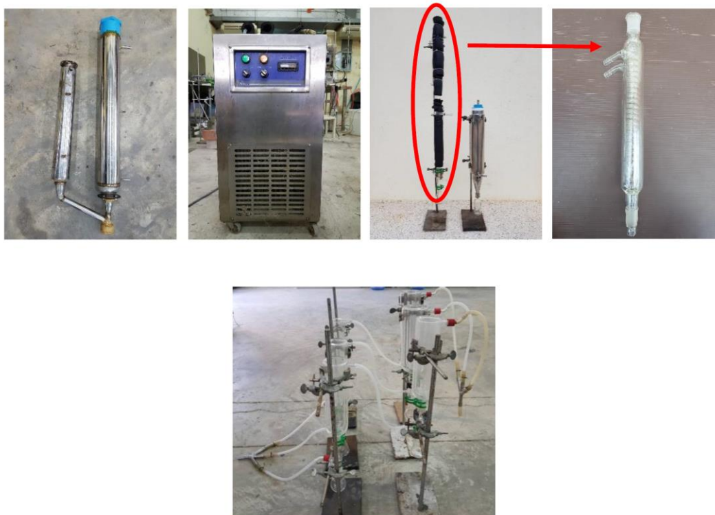
ภาพประกอบ 31 ชุดควบคุมแรงดัน ได้แก่ ชุดควบคุมแรงดันด้วยน้ำและชุดดักจับไฟฟ้าสถิต เครื่องทำความเย็น ชุดควบคุมแรงดันด้วยเครื่องทำความเย็น (ชุดคอยล์เย็น) และชุดควบคุมแรงดันน้ำแข็งแห้งผสมแอสซิโตน
