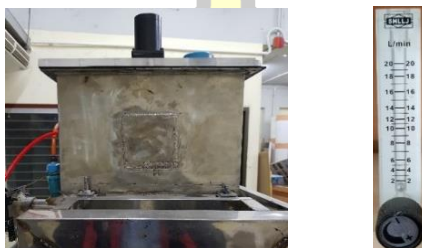
ภาพประกอบ 22 ถังเก็บชีวมวลและเครื่องวัดอัตราการไหลของแก๊ส
