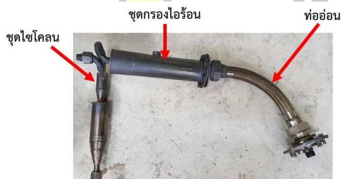
ภาพประกอบ 27 ชุดไซโคลน ชุดกรองไอร้อนและท่อเฟล็กซ์
