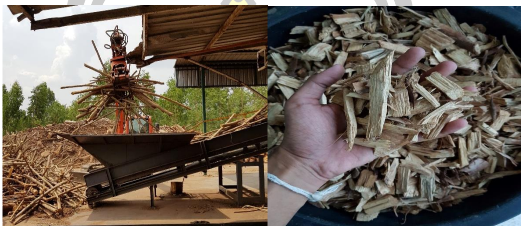
ภาพประกอบ 17 ชีวมวลจากโรงงาน (ซ้าย) ก่อนเข้าเครื่องบด และ (ขวา) หลังบดจากเครื่องบด
