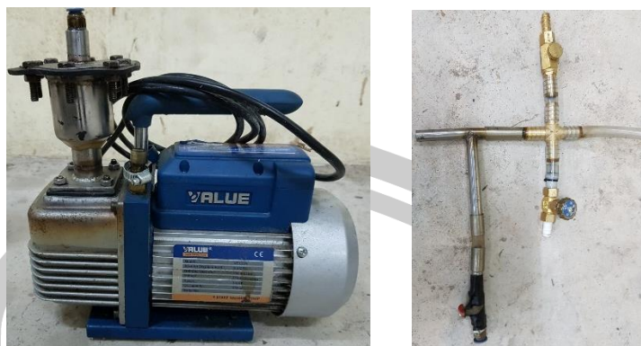
ภาพประกอบ 32 ปัมป์สุญญากาศและวาล์วปรับความดัน
